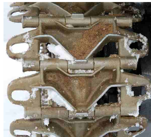
3. Звенчатая из цельноштампованных металлических траков с резино- металлическим шарниром (РМШ) Ширина - 390 мм Шаг - 128 мм
