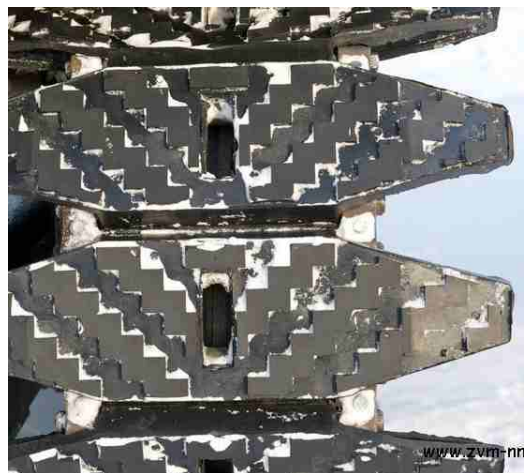
1. Асфальтоходная резиноармированная с параллельным резино- металлическим шарниром (РМШ) Ширина - 400 мм Шаг - 115 мм
